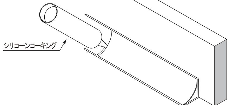
⚠ 隙間と突き合わせ（目地）部は必ずシールしてください。
