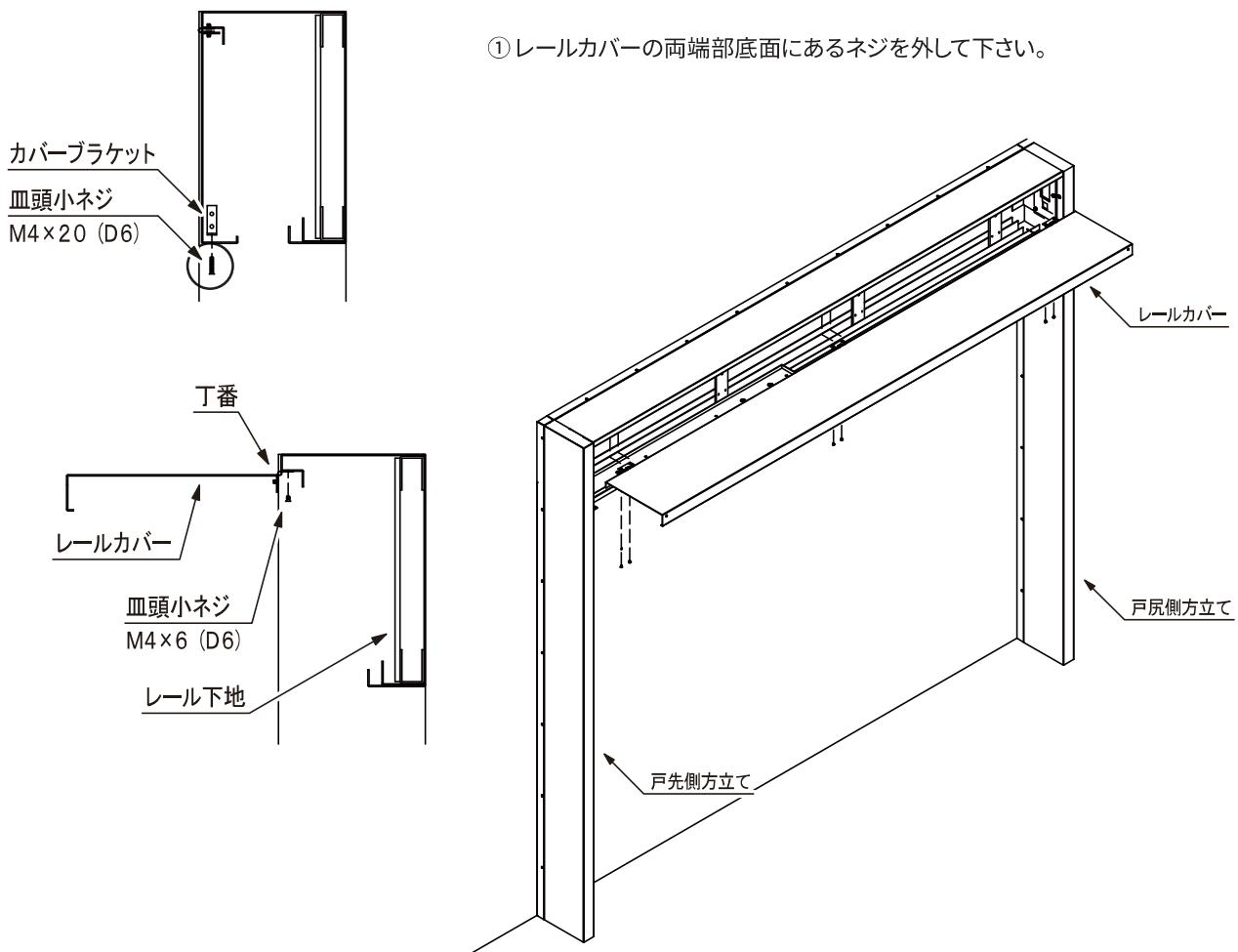
① レールカバーの両端部底面にあるネジを外して下さい。
